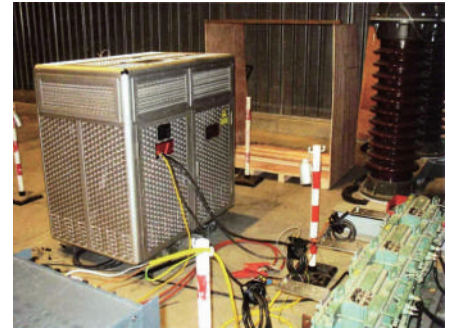
Erwärmungsprüfung bei der IPH Temperature-rise test at IPH
