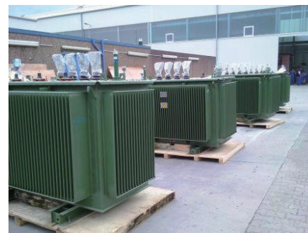
Gefertigte Öltransformatoren Finished oil-filled transformers
