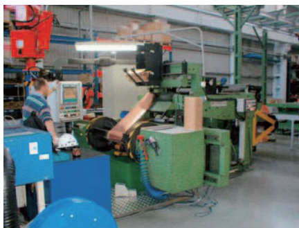
Herstellung der Unterspannungswicklung Production of low voltage winding
