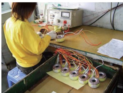
Qualitätskontrolle von Ringkerntrafos Quality control of toroidal transformers
