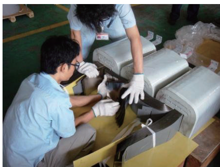
Schließen des amorphen Kerns Closing of amorphous core
