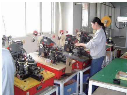
Herstellung von Ringkerntrafos Production of toroidal transformers
