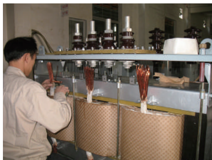
Verdrahtung eines Aktivteils für Ölrafo Assembly of oil transformers activ part
