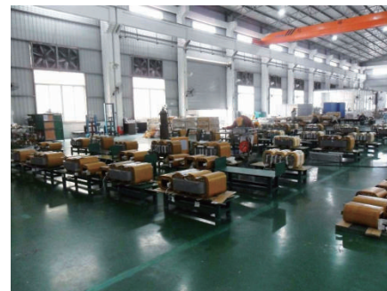
Produktion der Trafospulen Production of transformer coil
