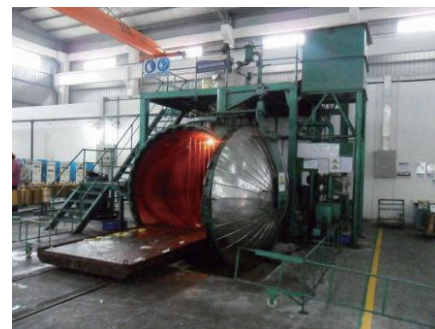
Vergussprozess im Vakuum Casting process in vacuum
